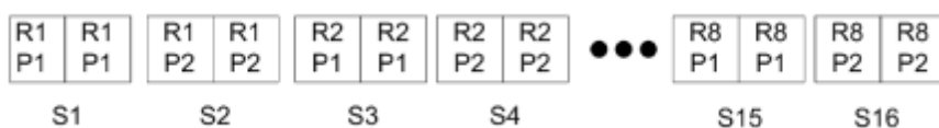
Figura 2: Exemplo da imposição de registro único utilizando Agrupamento único para 8 registros, 2 páginas por registro, layout de 1 fileira x 2 colunas, simplex. R = registro, P = página, F = folha.
