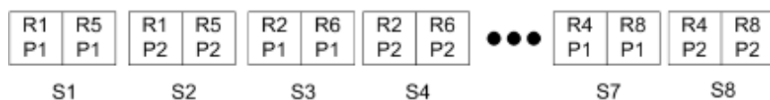
Figuur 6: Voorbeeld van Snijden en stapelen voor 8 records, 2 pagina's per record, opmaak met 1 rij x 2 kolommen, enkelzijdig. R = Record, P = Pagina, S = Vel
