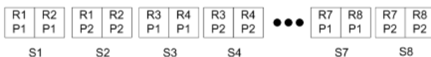
Figuur 5: Voorbeeld van Meerdere records collationeren voor 8 records, 2 pagina's per record, opmaak met 1 rij x 2 kolommen, enkelzijdig. R = Record, P = Pagina, S = Vel
