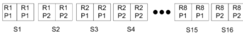
図 1: ギャングアップ反復を使用した単一レコード面付けの例 (8 レコード、1 レコードあたり 2 ページ、1 行 x2 列のレイアウト、片面印刷、R=レコード、P=ページ、S=シート)
