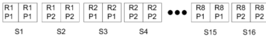
Abbildung 2: Beispiel für das Ausschießen eines einzelnen Datensatzes über „Sammelform einmal“ für 8 Datensätze, 2 Seiten/Datensatz, Layout: 1 Zeile x 2 Spalten, Simplex. R = Datensatz, P = Seite, S = Bogen
