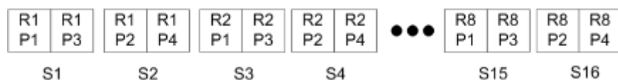
Figura 3: Exemplo de imposição de registro único utilizando Único - Intercalar e cortar para 8 registros, 4 páginas por registro, layout de 1 fileira x 2 colunas, simplex. R = registro, P = página, F = folha.
