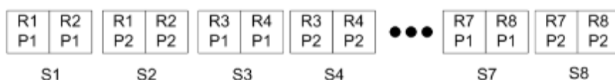
Abbildung 4: Die folgende Abbildung veranschaulicht die Ausgabe für die Sammelform „Mehrsatzmodus – Sortieren“ bei folgenden Festlegungen: Sammelform = Mehrsatzmodus – Sortieren // 8 Datensätze und 2 Seiten pro Datensatz // Layout mit 1 Zeile und 2 Spalten // Simplexdruck (R = Datensatz, P = Seite, S = Bogen)
