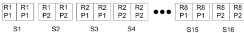
Figura 2: Ejemplo de imposición de un solo registro utilizando Único N por cara para un diseño de 8 registros, con 2 páginas por registro, 1 fila X 2 columnas, a una cara. R = Registro, P = Página, H = Hoja.
