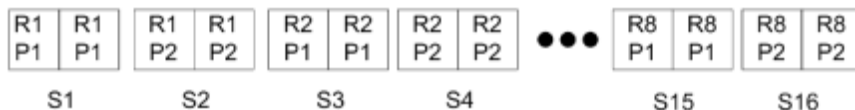
Figure 1 : Exemple d'imposition d'un seul enregistrement utilisant l'impression groupée plusieurs fois pour 8 enregistrements, avec 2 pages par enregistrement, une mise en page d'une ligne sur deux colonnes et en recto. « R » correspond à Enregistrement (Record), « P » à Page et « S » à Feuille (Sheet).
