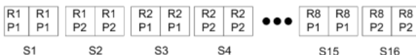
Figura 1: Ejemplo de imposición de un solo registro utilizando Repetir N por cara para un diseño de 8 registros, con 2 páginas por registro, 1 fila x 2 columnas, a una cara. R = Registro, P = Página, H = Hoja.
