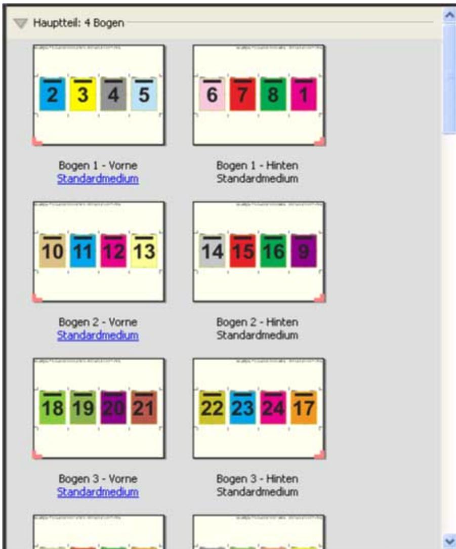
Ein mit der Schablone 4-fach, Zickzackfalz erstellter Bogen wird in der Regel wie in folgender Abbildung dargestellt gefalzt.
