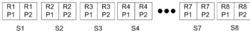
Rysunek 3: Przykład impozycji pojedynczego rekordu z zastosowaniem ustawienia Wytnij unikatowe- posegregowane dla 8 rekordów (4 strony na rekord, układ 1 wiersz x 2 kolumny, druk jednostronny). R = rekord, P = strona, S = arkusz.
