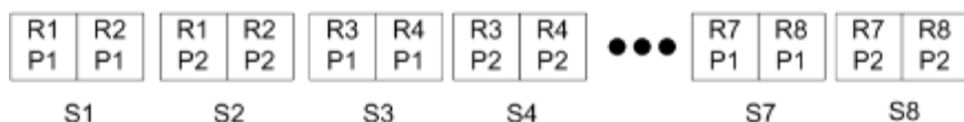
Rysunek 5: Przykład zastosowania funkcji Segregowanie wielu rekordów w przypadku układu jednostronnego obejmującego 8 rekordów, z 2 stronami na rekord, 1 wierszem na 2 kolumny. R = rekord, P = strona, S = arkusz
