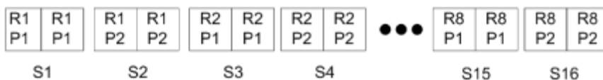
Abbildung 1: Beispiel für das Ausschießen eines einzelnen Datensatzes über „Sammelform mehrmals“ für 8 Datensätze, 2 Seiten/Datensatz, Layout: 1 Zeile x 2 Spalten, Simplex. R = Datensatz, P = Seite, S = Bogen
