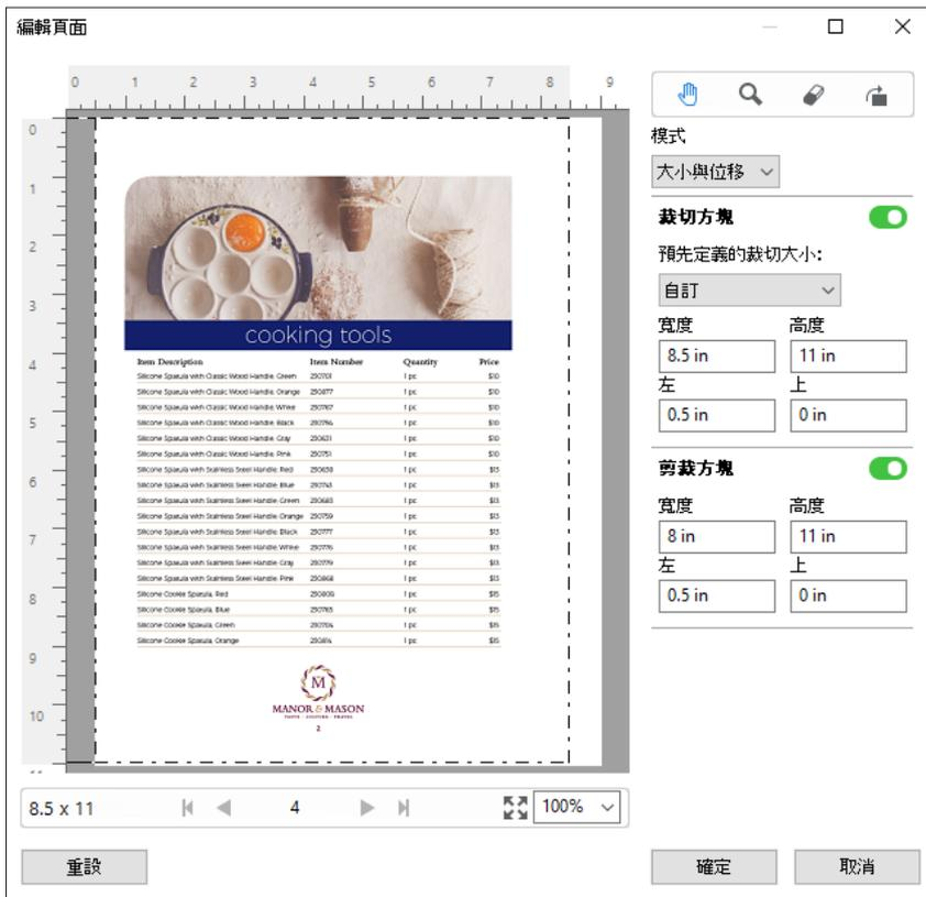
對於需要在頂端邊緣打孔加工的工作，使用者已在剪裁方塊的上欄位輸入負數值（請參閱以下範例）。雖然剪裁方塊維持原來的大小，不過因為內容已向下移動，所以能騰出較多空間供使用者打孔。請注意，儘管預先定義的裁切大小選項未啟用，不過使用者依然可以變更寬度和高度欄位中的值。
