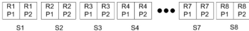
Figure 2 : Exemple d'imposition d'un seul enregistrement utilisant l'impression groupée unique pour 8 enregistrements, avec 2 pages par enregistrement, une mise en page d'une ligne sur deux colonnes et en recto. « R » correspond à Enregistrement (Record), « P » à Page et « S » à Feuille (Sheet).
