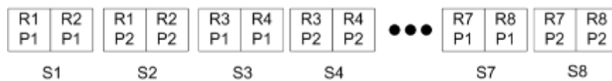
Figura 4: Exemplo de Intercalação multirregistro para 8 registros, 2 páginas por registro, layout de 1 linha x 2 colunas, simplex. R = Registro, P = Página, S = Folha
