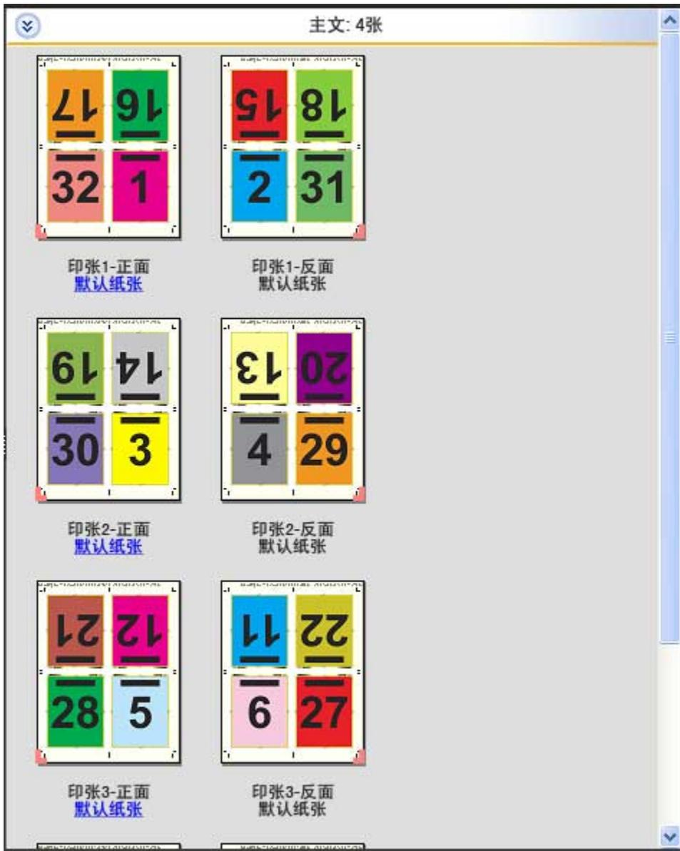
“四合一头对头”通常折叠成如下图所示。如果要折叠多个印张，必须将所有印张堆叠在一起同时折叠。
