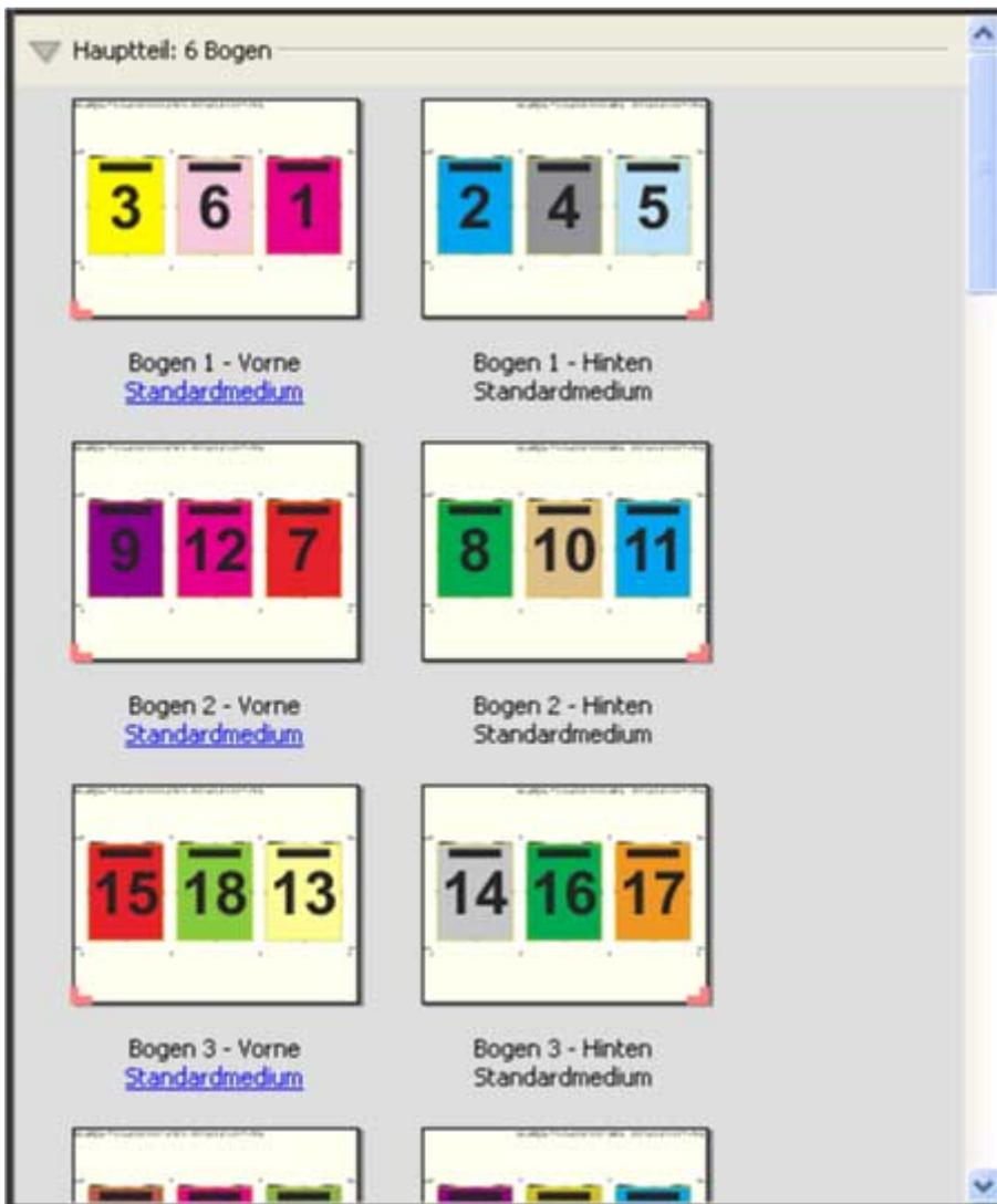
Ein mit der Schablone „3-fach, Wickelfalz“ erzeugter Druckbogen wird i. d. R. wie folgt gefalzt:
