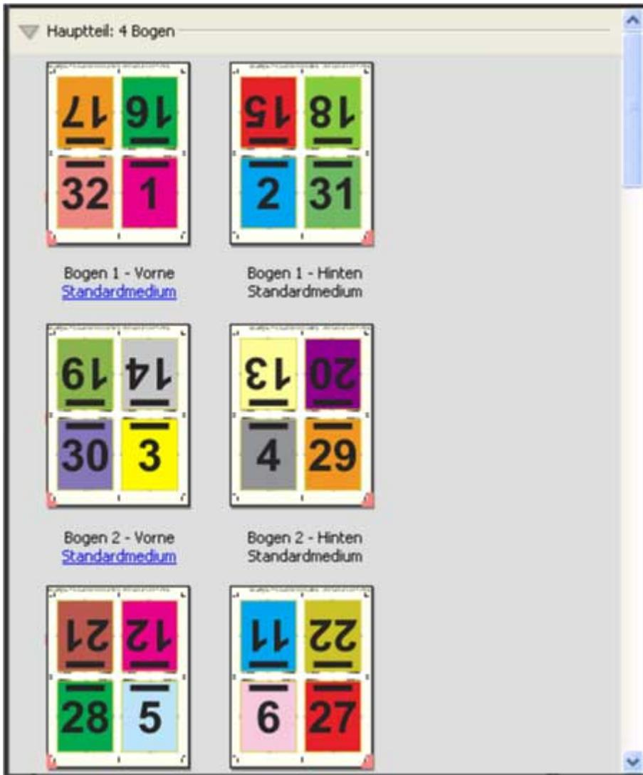
Ein mit der Schablone „4-fach, Kopf an Kopf“ erzeugter Druckbogen wird i. d. R. wie folgt gefalzt: Mehrere Bogen müssen aufeinander gelegt und als Gruppe gefalzt werden.
