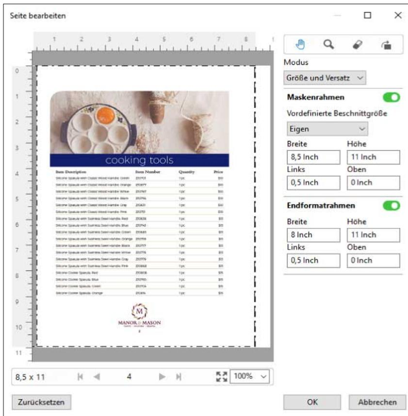
Bei einem Auftrag, der an der oberen Kante gelocht werden soll, muss der Anwender einen negativen Wert im Feld Oben für Endformatrahmen eingeben (siehe Beispiel unten). Die Größe für den Endformatrahmen wurde beibehalten, der Inhalt wurde jedoch nach unten verschoben, sodass mehr Raum für die Lochung bleibt. Beachten Sie, dass die Option Vordefinierte Beschnittgröße nicht aktiviert ist, der Anwender kann aber die Werte in den Feldern Breite und Höhe ändern.
