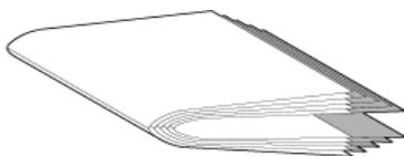
Der Randbeschnitt für die Seiten nach dem Binden löst das Problem jedoch nur zum Teil, ähnlich wie sich die Kanten der Seiten verschieben, verschieben sich auch die gedruckten Inhalte auf den einzelnen Seiten. Dieser Zuwachs, der sich durch das mehrfache Falzen eines Bogens ergibt, wird durch den so genannten Bundzuwachs ausgeglichen. Der Bundzuwachs führt dazu, dass sich der Inhalt der innersten Seiten in Richtung der äußeren Ränder der Seite zu verschieben scheint.
